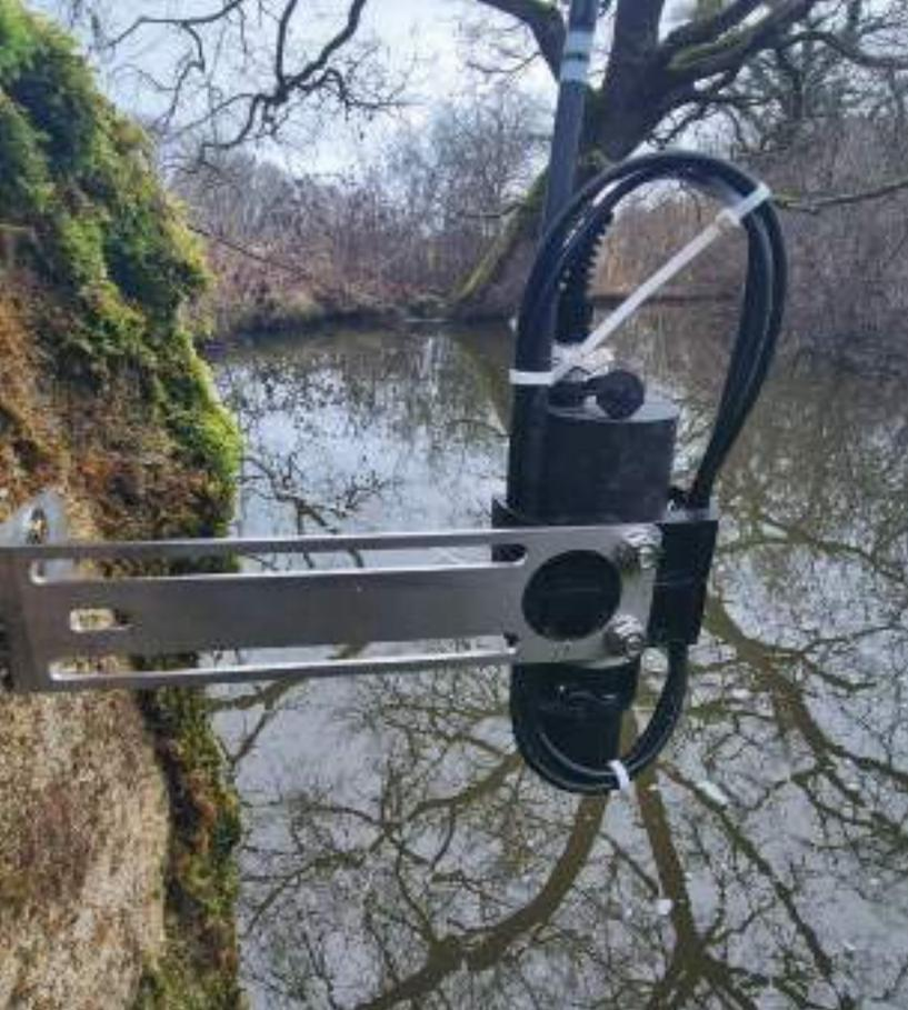
A l'Ermite, l'une des quatre sondes radar installées cette année pour suivre les hauteurs d'eau en entrée et en sortie de l'étang © L. Boulesteix/CD23
